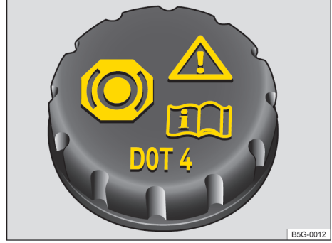
الشكل 149: داخل المقصورة الأمامية: غطاء حاوية سائل الفرامل
