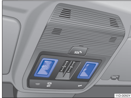
الشكل 76 في الكونسول الوسطي العلوي: ضوء قراءة حساس للمس
